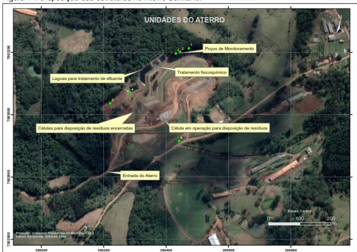
Figura 14: Disposição das estruturas no Aterro Sanitário.
